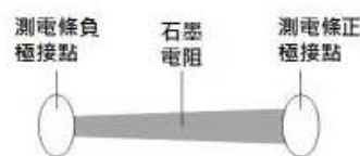
圖2 測電條的石墨電阻元件
